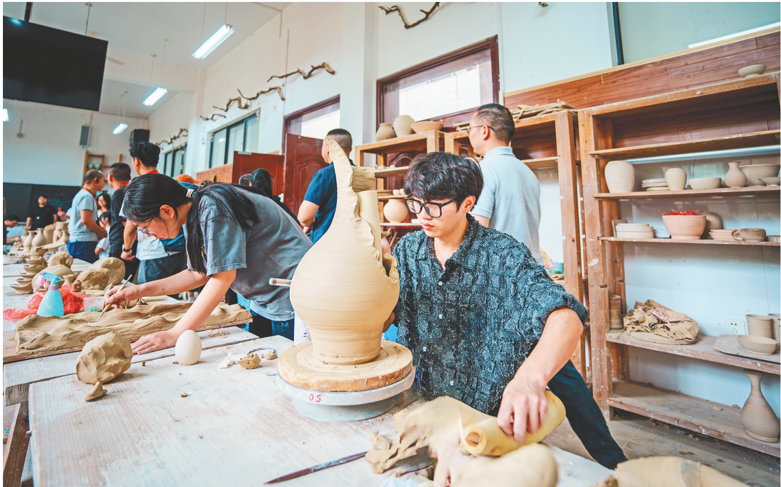
龙泉青瓷宝剑技师学院学生正进行拉坯后的变形装饰改造。 记者 贾恒 柳永伟 摄
