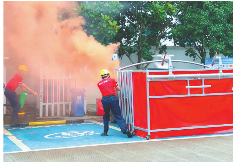
近日,中国石化丽水分公司研发的“一种汽车起火隔断装置”获国家实用新型发明专利授权。该装置采用模块化设计,通过框架的可伸缩结构搭配防火布形成阻隔区,能将起火汽车快速隔离,并通过主体上配置的水枪形成水幕,有效阻止火势蔓延至邻近车辆或建构筑物,为降低电动汽车火灾损失提供了一种创新方案。 记者 徐小骏 通讯员 张小凤 摄
