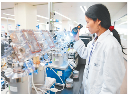
2025年3月21日,在位于苏州工业园区的沛嘉医疗科技(苏州)有限公司测试实验室里,检测人员使用频闪仪检查正在疲劳测试中的人工心脏瓣膜开闭形态。 新华社发(陈雨禾 摄)
