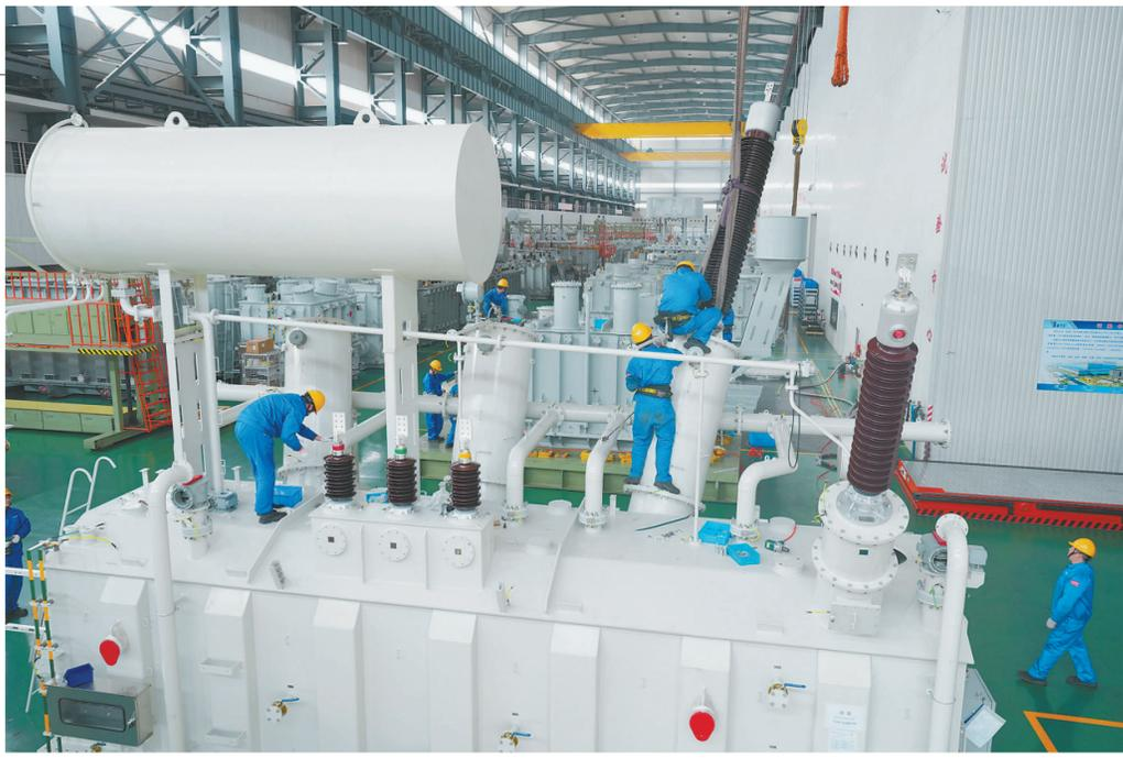
4月1日,在浙江白云浙变电气有限公司,工作人员在厂房装配22万伏特高压油浸式变压器。该公司输变电设备出口全球,一季度产值达2.2亿元。开年以来,浙江省绍兴市上虞区工业生产稳健运行。当地以打造先进制造业基地为目标,加快建设现代化产业体系,一批重大项目建设持续推进及投产。1至2月,上虞区实现规模以上工业增加值75.4亿元,居全市第一。新华社记者 翁忻旸 摄
