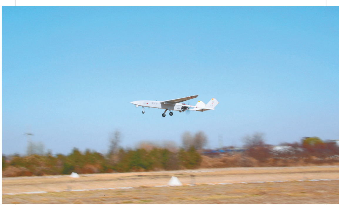
3月18日上午，长航时大载重无人运输机“宝云号”在河北衡水成功首飞。“宝云号”是由衡水桃城机场完全自主研发的长航时大载重无人运输机，最长航时26个小时，比现有续航10小时左右的同类机型续航能力增长超一倍。相较于同类机型每架500万到1000万元的价格，它仅需150万元。这为无人运输机广泛投入应用提供了可能。
