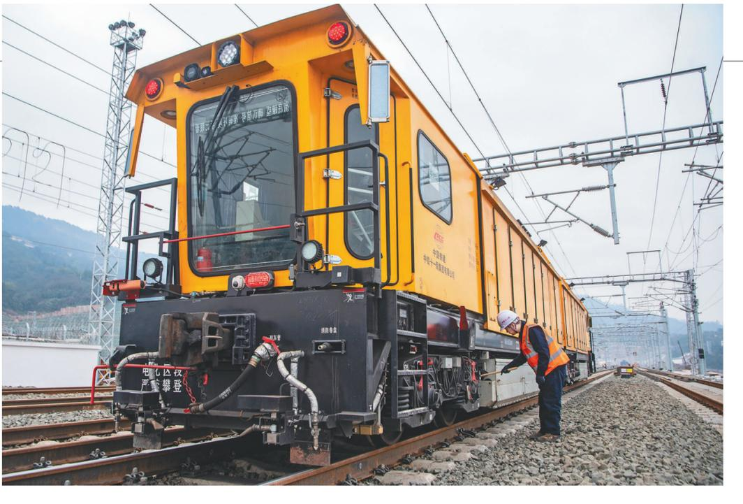
2月18日,在重庆东站建设施工现场,中铁十一局的铁路工人在查看钢轨打磨车的运行状态。
