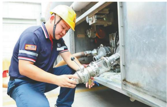
近日,中国石化丽水石油依托技师工作室创新平台研发的“油罐车卸油装置”获国家实用新型发明专利。该卸油装置能让卸油员在密闭卸油过程中通过高强度的透明管段直观检查油品的颜色和无杂质,从而判断油品质量,可有效解决卸油作业中的安全、环保及油品泄漏等难题。该技术将在全省推广使用,预计每年可减少油气挥发超千吨。
