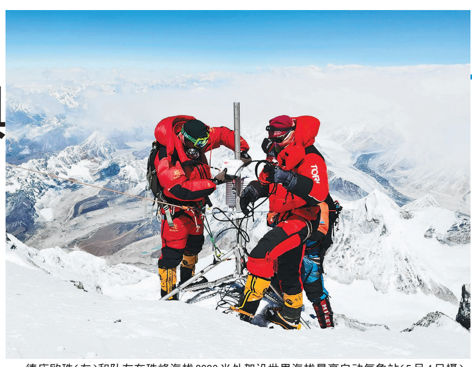
德庆欧珠(左)和队友在珠峰海拔8830米处架设世界海拔最高自动气象站(5月4日摄)。
