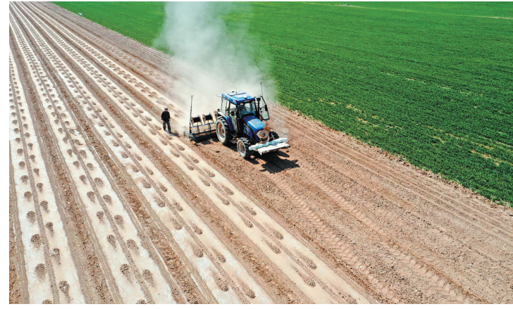
在新疆生产建设兵团第六师共青团农场,一台安装北斗导航自动驾驶系统的播种机在播种棉花。
