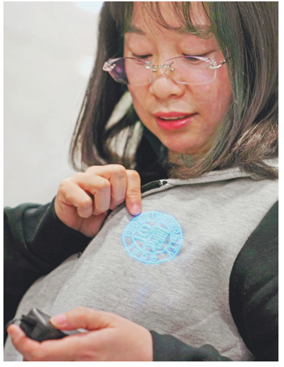
复旦大学科研人员展示衣服上用发光纤维绣制的“复旦大学”标志,接通电源后,图案发出明亮蓝光。
