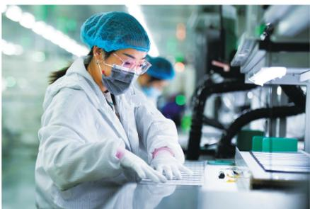
工人在浙江义乌的晶科能源(义乌)有限公司生产车间进行太阳能组件的焊接工序(2021年1月15日摄)。
