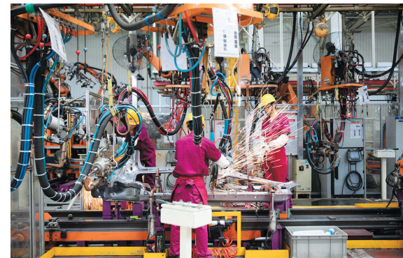
在安徽江淮汽车集团股份有限公司安庆分公司新能源汽车生产车间,工人在焊接新能源纯电动车配件(2018年8月7日摄)。
