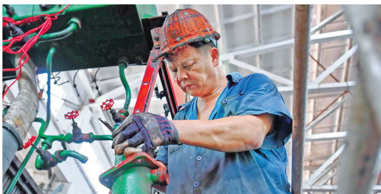
7月24日,中国铁路南昌局集团有限公司福州机务段的检修工苏尔玉在对内燃机油水管路进行检修,确保列车在高温下运行安全。
