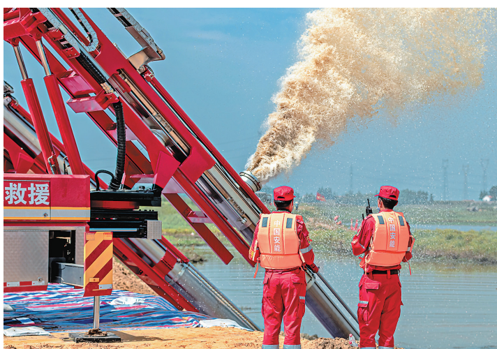
工作人员操作垂直式供水排水抢险车(2020年5月31日摄)。
