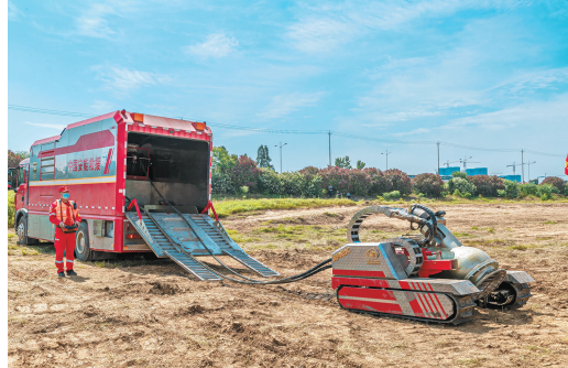
这是子母式排水抢险车。在急需抽排积水的狭小空间,小巧的“子车”可在积水中顺畅前行,可360度旋转,涉水深度超过2米(2020年5月31日摄)。
