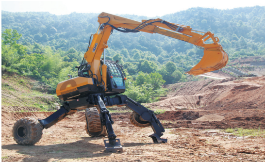
这台步履式挖掘机适用于复杂地形爆破钻孔、岩石破碎、重物搬运、吊装等作业(2016年5月25日摄)。
