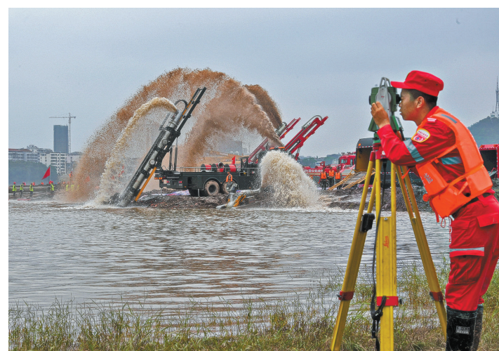
中国安能建设集团工作人员使用全站型电子测距仪测量水位水情(2020年6月12日摄)。
