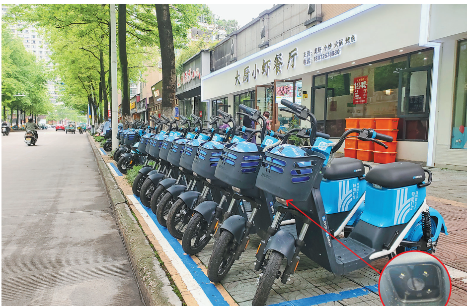
安装在车篮下的摄像头可以控制车辆精准停在蓝白线框内。
